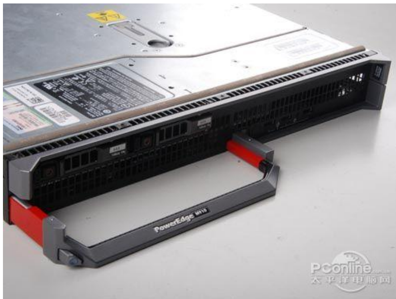
M910 同样配置了两块热插拔硬盘
