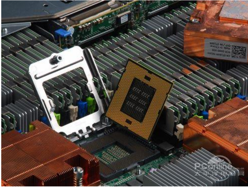
采用触点式设计的 Nehalem-EX ( Xeon 7400 采用的则是针脚式 )
