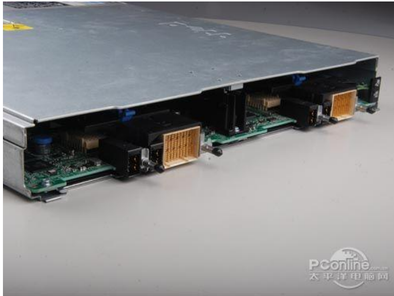
M910 背部电源接口，全高的 M910 有两个连接模块
