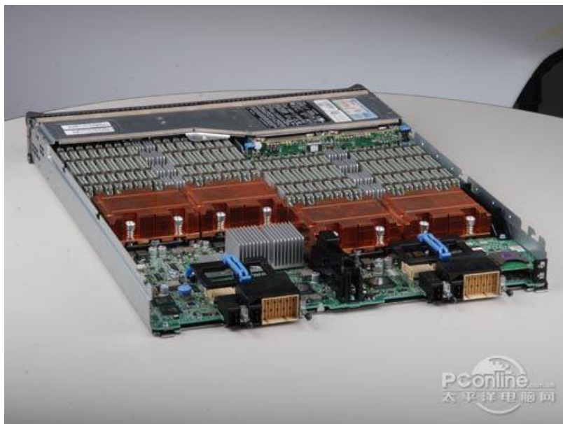
共有 4 个 CPU 插槽和 32 个 DIMM 插槽
